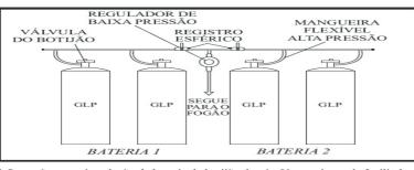
\* Sugestões para instalação de bateria de botijão de gás. Um conjunto de 2 cilindros operando e o outro conjunto também de 2 cilindros, cheio e pronto para uso.
